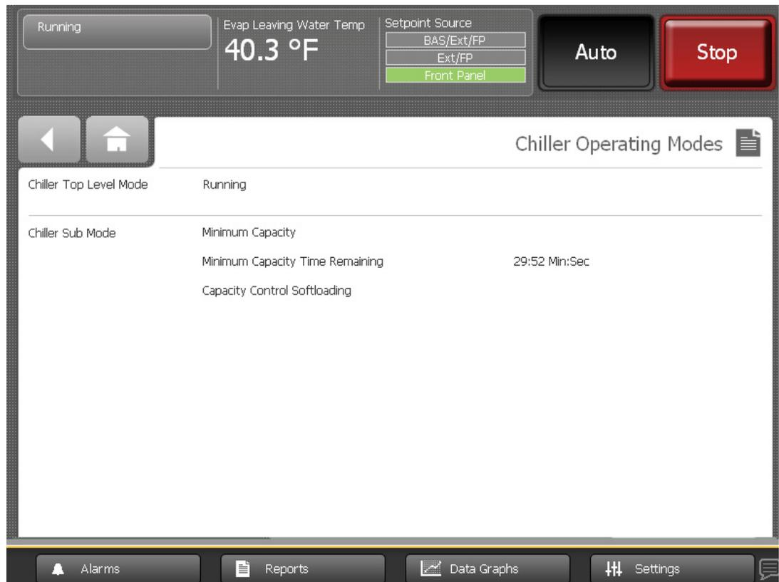
Las enfriadoras CVHE, CVHF y CVHG operan en uno de los modos de operación de nivel superior que se muestran en la Tabla 5. La tabla ofrece una descripción de los modos de operación de nivel superior y enumera los submodos que corresponden a cada uno de dichos modos.
