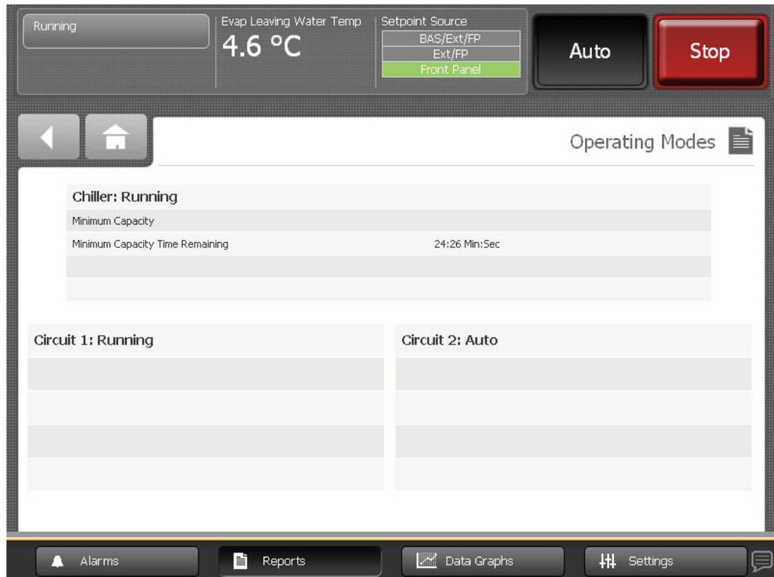
En las enfriadoras dúplex CDHF o CDHG, la pantalla de modos de operación de la enfriadora muestra los modos de nivel superior y los submodos de la enfriadora (Tabla 3, página 32) y de los circuitos (Tabla 7, página 33). Cada tabla muestra los modos de nivel superior en la columna izquierda, una descripción en la columna del centro y los modos correspondientes en la columna de la derecha.
